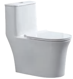
品名: 陶瓷马桶 型号: OLS-968TZ 尺寸: 725*375*750mm 坑距: 305/400mm 冲水方式: 喷射虹吸
