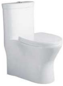
品名: 陶瓷马桶 型号: OLS-967 尺寸: 720*360*770mm 坑距: 305/400mm 冲水方式: 漩涡虹吸
