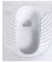
品名: 蹲便器 型号: OLS-2009SQ/H 尺寸: 560*460*235mm 排水方式: 前出水/后出水 管道: 带存水弯
